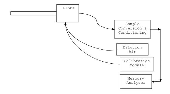
FIGURE A-1. TYPICAL MERCURY CEMS
